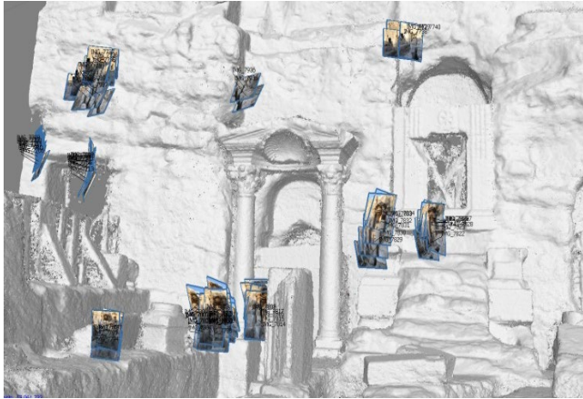
Şekil 6. Fotogrametri için fotoğraf çekme açıları ve sistemi.
