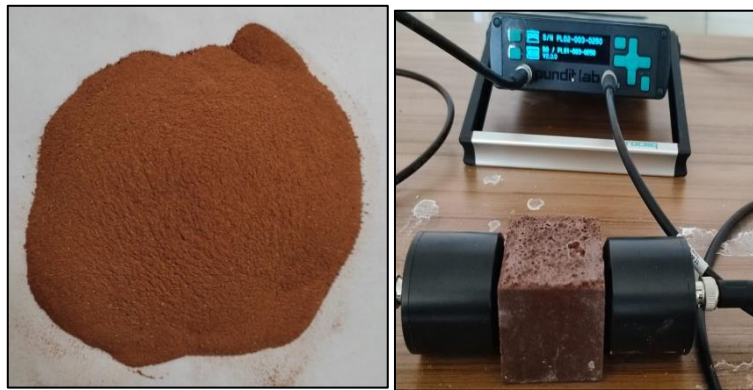
Şekil 4. Atık tuğla tozu ve üretilen numune
