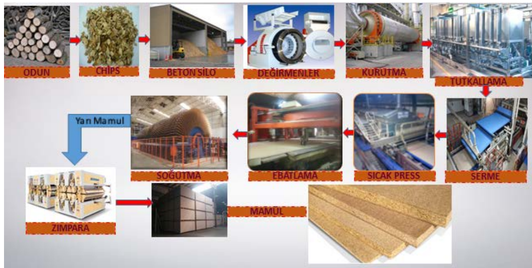
Şekil 1. Yonga levha üretim aşamaları.
