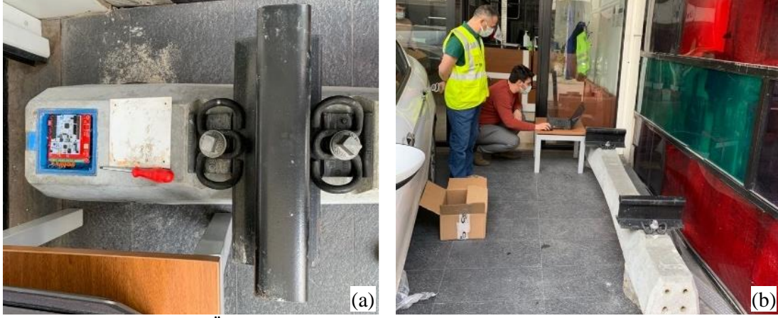
Şekil 6. (a) Üretilen akıllı travers prototipi ve (b) Laboratuvar deneyleri
