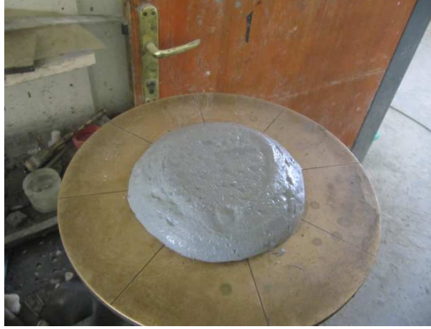
Şekil 2. Karışımın yayılma tablasındaki görünümü.
