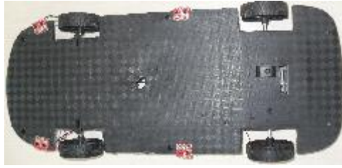
a)Temsili Aracın Alt Panelindeki Algılayıcıların Görünümü
