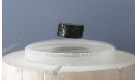
Şekil 2. Manyetik havada asılı kalma (Hackett, 2015)
