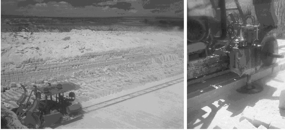
Şekil 4. Derbent kesme taş ocağındaki üretim yöntemi ve kesme makinasının görünümü
