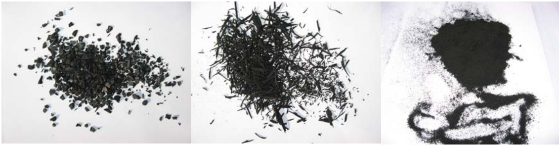
Şekil 7. a) Sert plastik parçalar b) Araç lastiği parçacıkları c) Lastik tozu.
