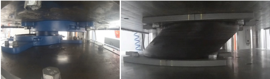
Şekil 5. Sürtünmeli sarkaç izolatör ve kurşun çekirdekli kauçuk izolatör deneyi. ESQUAKE Sismik İzolatör Test Laboratuvarı. (Fotoğraf: Prof. Dr. Gökhan Özdemir)
