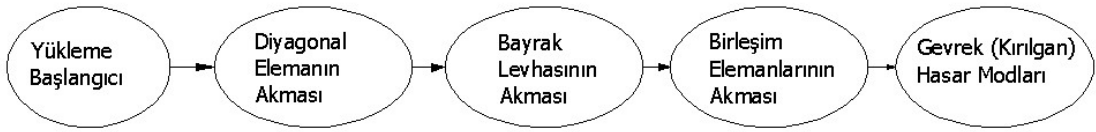
Şekil 9. Çelik çaprazlı çerçeve elemanlarında hasar oluşum sıralaması, [4].
