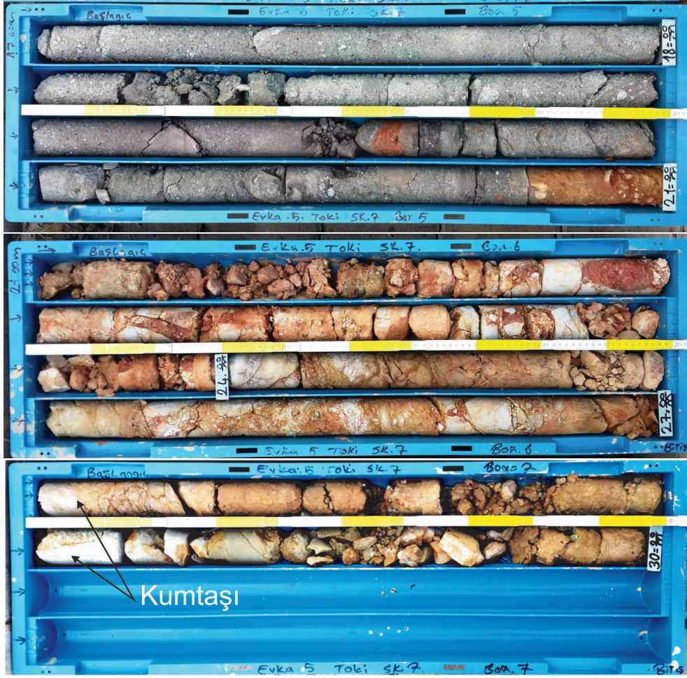
Şekil 13. SK-7 sondaj kuyusunda, 21 m derinliğinde aglomera-filyş dokanağında gelişmiş oksitlenme-pişme nedeniyle meydana gelen pembe renkli breşik zon (F 3 fay zonu, 20.8 - 21.0 m arası fay kili ve 21.1 - 21.55 m arası da fay breşi olarak değerlendirilmiştir). Figure 13. In BH-7 borehole, down to 21 m from the ground surface, breccia zone with pink colour occurred due to oxidation and baking in the contact between agglomerate and flysch units.
