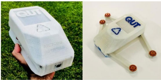
Şekil 25. Çalışma sonucunda elde edilen katlanabilir geri dönüştürülmüş İHA (Mosaddek vd., 2018).
