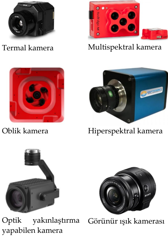
Şekil 3. İHA üzerinde entegre edilebilen kamera türleri (Villi & Yakar, 2022).
