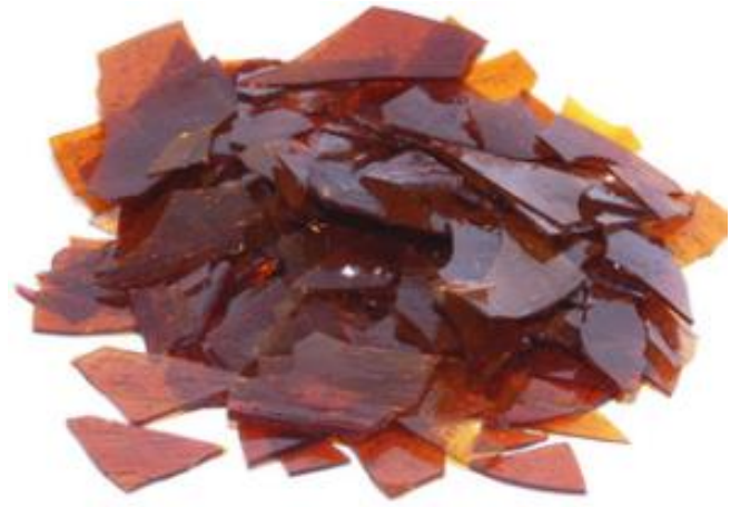
Şekil 1. Şellak pullar. Figure 1. Shellac flakes.
