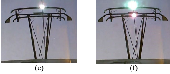
Şekil 16. Pantograf ark tespiti için kullanılan video görüntüleri (Video images used for pantograph arc detection)
