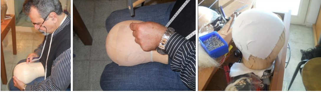
Görsel 22. Ölçüyle kalıba altlık germe
