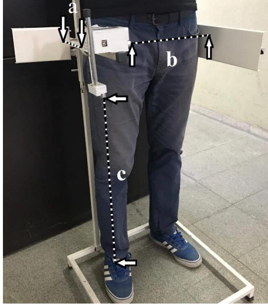
Şekil 4. Tasarlanan ölçüm platformu ve cihazın “a,b ve c” parametrelerini ölçümü
