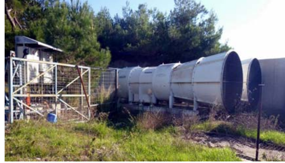
Şekil 1. Yeraltı madenlerinin havalandırmasında kullanılan emici fanlar
