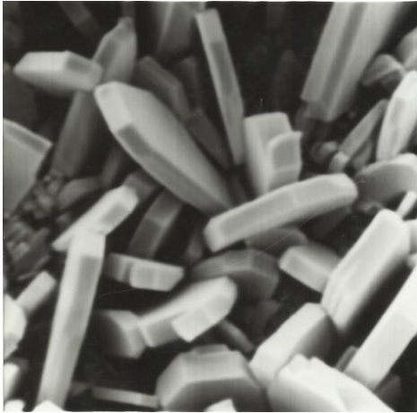
Şekil 3: Klinoptilolit örneği SEM görünümü Figure 3. SEM view of clinoptilolite
