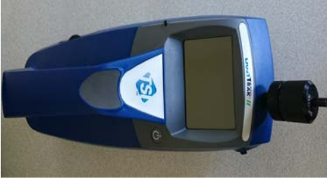
Şekil 2. TSI Dusttrak II 8532 Toz Ölçüm Cihazı
