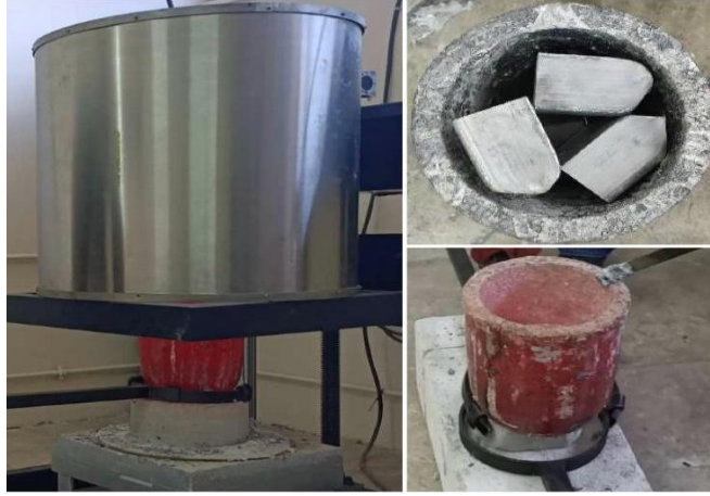
Şekil 2. Ergitme işlemlerinin yapıldığı çan tipi elektrik direnç ocağı Figure 2. Bell-type electric resistance furnace
