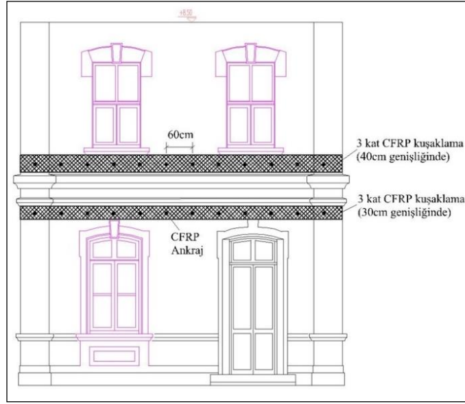
Şekil 4.3.4. CFRP kuşaklama (Figure 4.3.4. CFRP application)
