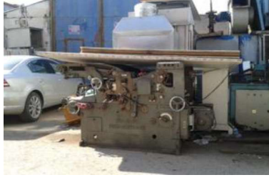
Görsel 5. Hurdaya ayrılmış M.A.N POLY-AUTOMAT modeli kazanlı tipo baskı makinası, 2015, Hurdacılar Sitesi, Ankara.
