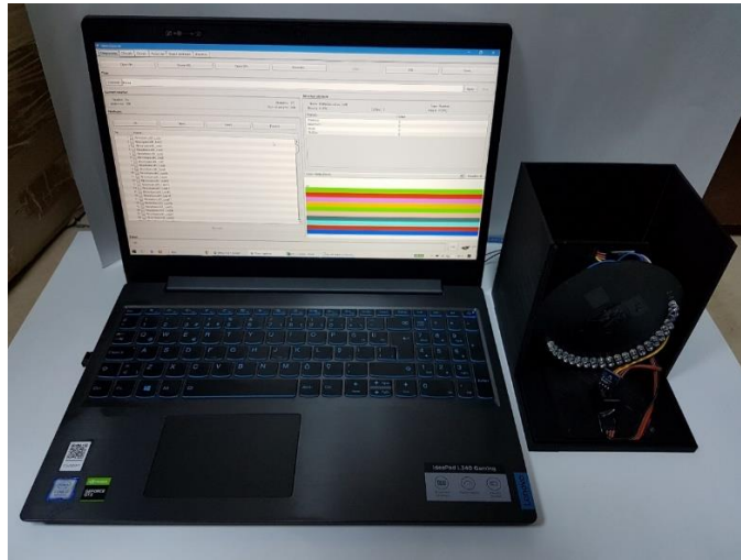
Şekil 2. Süt deneylerinde kullanılan yapay sinir ağı destekli ölçüm sistemi
