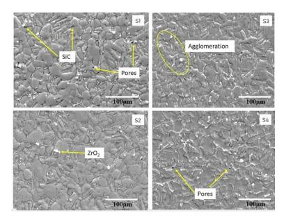
Figure 7. SEM Images of, (S1). Al - 5w/w.% SiC, (S2). Al - 5w/w.% SiC - 5w/w.% ZrO<sub>2</sub>, (S3). Al - 5w/w.% SiC - 10w/w.% ZrO<sub>2</sub>, (S4). Al - 5w/w.% SiC - 15w/w.% ZrO<sub>2</sub>
