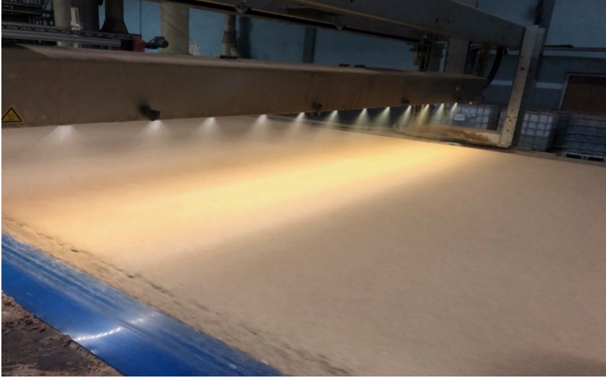
Şekil 2. Levha taslağı üzerine KAK püskürtme işlemi.
