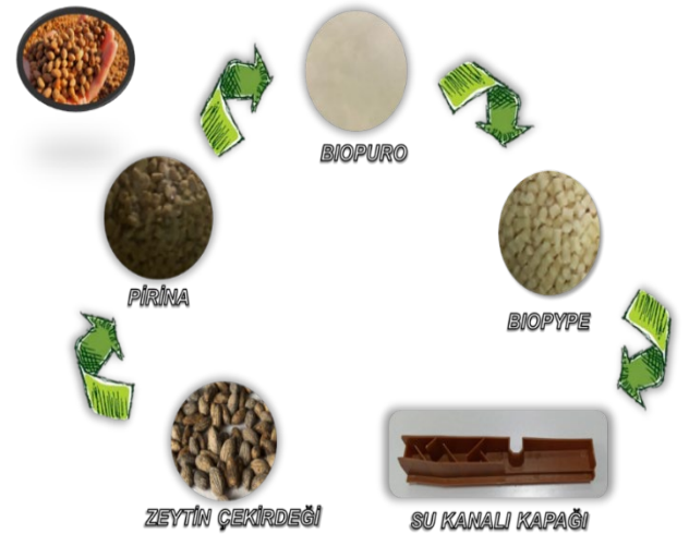
Şekil 20. Zeytin çekirdeğinden çamaşır makinesi su kanalı kapağı üretim aşamaları (Vestel Ventures Dergisi, 2023)
