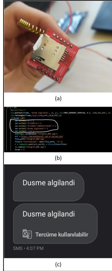
Şekil 13. a) Sim8001 GSM modülü b) Sms için tasarlanan kod bütünü ve c) İstenilen mesaj bilgisinin gönderilmesi
