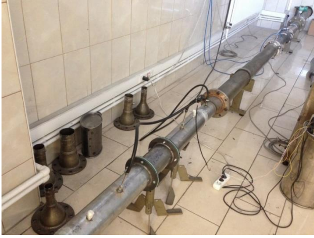
Şekil 4. Partikül filtresinin test edilmesi (Testing of the particulate filter)
