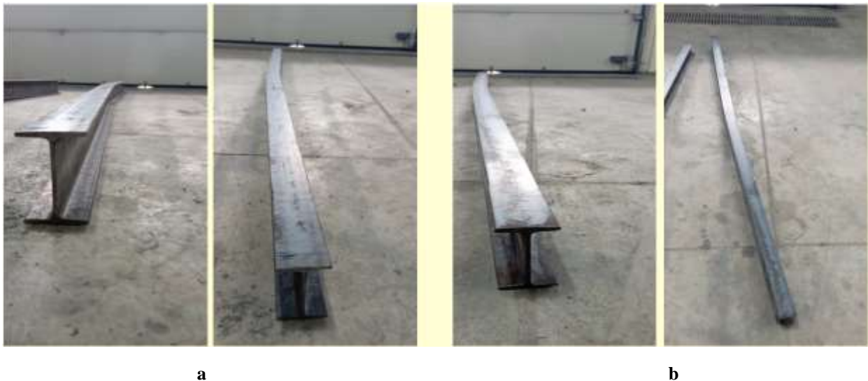
Şekil 5 a) %10 eksen kaçıklıklı deney resimleri (D3) b) %15 eksen kaçıklıklı deney resimleri (D4)
