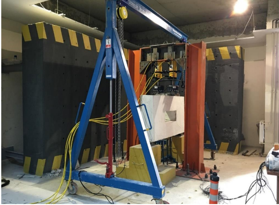
Şekil 4: Rijit yükleme çerçevesi ve deney düzeneği
