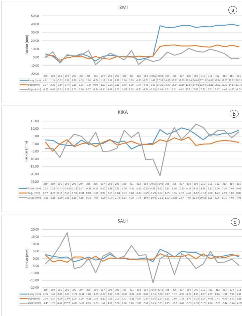
Şekil 8. OPUS servisine dayalı (a) İzmir, (b) Kırkağaç ve (c) Salihli istasyonlarının yer değiştirme grafikleri Figure 8. Displacement graphs of (a) İzmir, (b) Kırkağaç and (c) Salihli stations based on OPUS service
