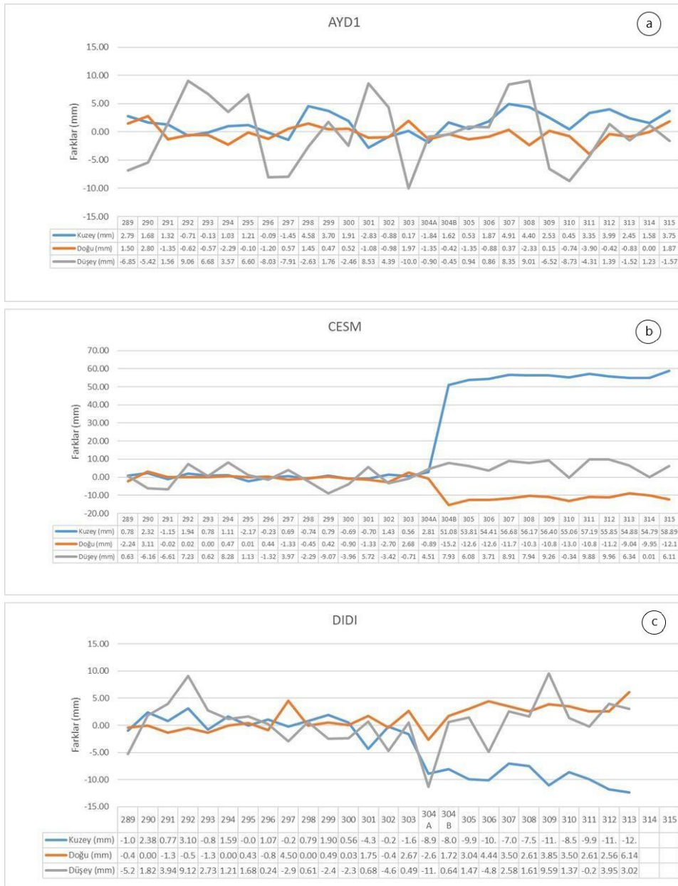
Şekil 7. OPUS servisine dayalı (a) Aydın, (b) Çeşme ve (c) Didim istasyonlarının yer değiştirme grafikleri Figure 7. Displacement graphs of (a) Aydın, (b) Çeşme and (c) Didim stations based on OPUS service
