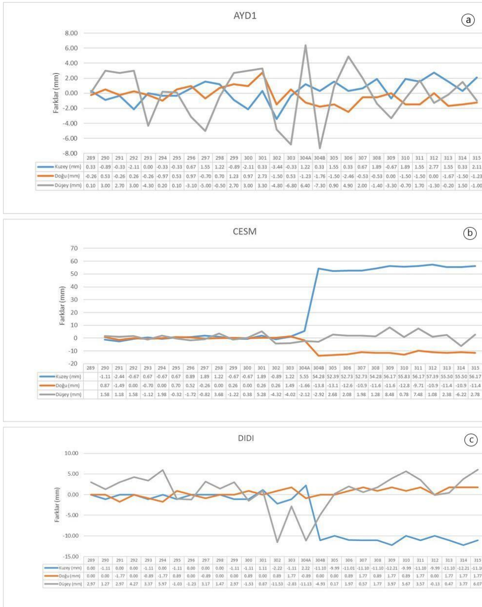
Şekil 4. CSRS-PPP servisine dayalı (a) Aydın, (b) Çeşme ve (c) Didim istasyonlarının yer değiştirme grafikleri Figure 4. Displacements graphs of (a) Aydın, (b) Çeşme and (c) Didim stations based on CSRS-PPP service
