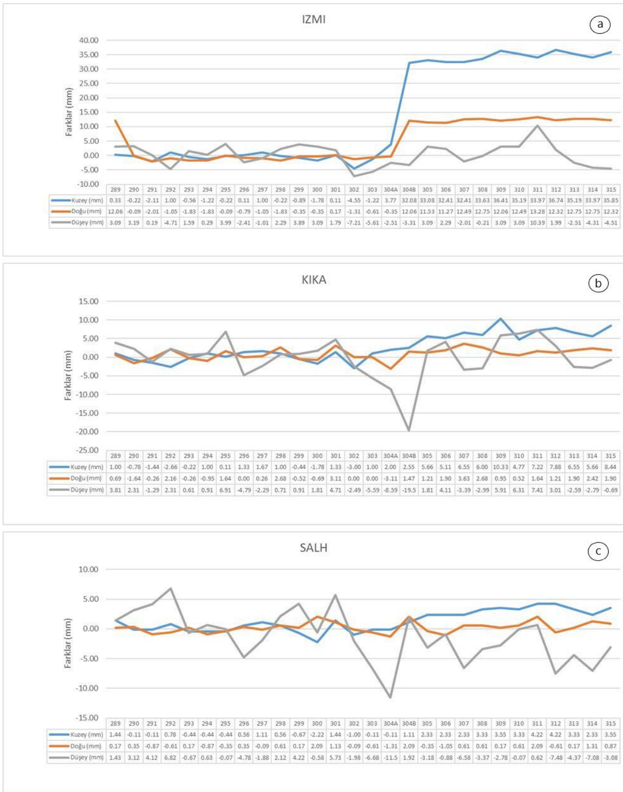
Şekil 5. CSRS-PPP servisine dayalı (a) İzmir, (b) Kırkağaç ve (c) Salihli istasyonlarının yer değiştirme grafikleri
