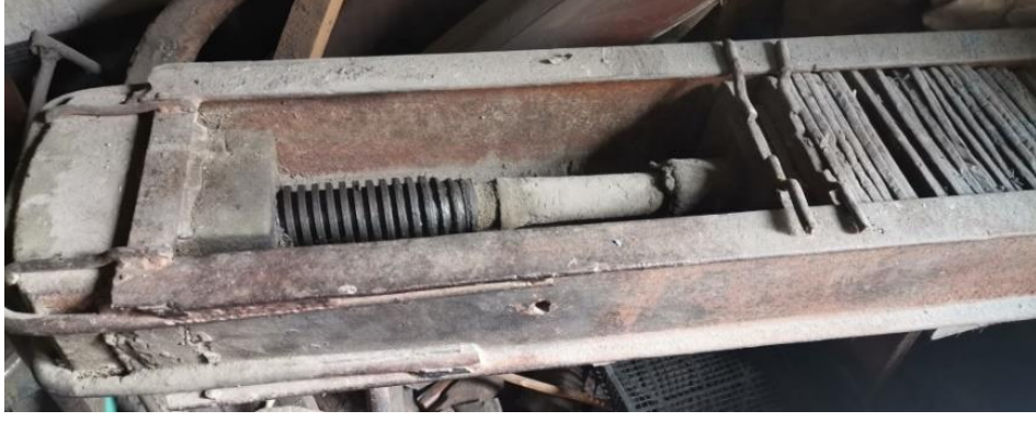
Görsel 13. Taslağın düzeltilmesi için kullanılan mengene Kaynak: (Gülen, 2023)
