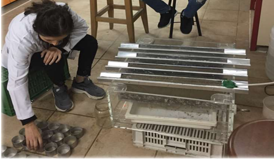
Şekil 1. Parmak erozyonu ölçüm çalışmasından görünüm (mini-flume düzenenği)
