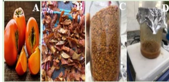
Şekil 1. Diospyros kaki kabuklarından özüt hazırlanması: A: Diospyros kaki (Trabzon hurması) B: Meyve kabuklarının kurutulması C: Kurutulmuş kabukların küçük parçacıklara ayrılması D: NP üretimi için hazırlanan özüt
