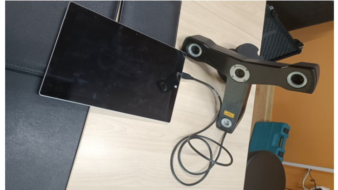
Şekil 3. FARO Freestyle 3B Tarayıcı.
