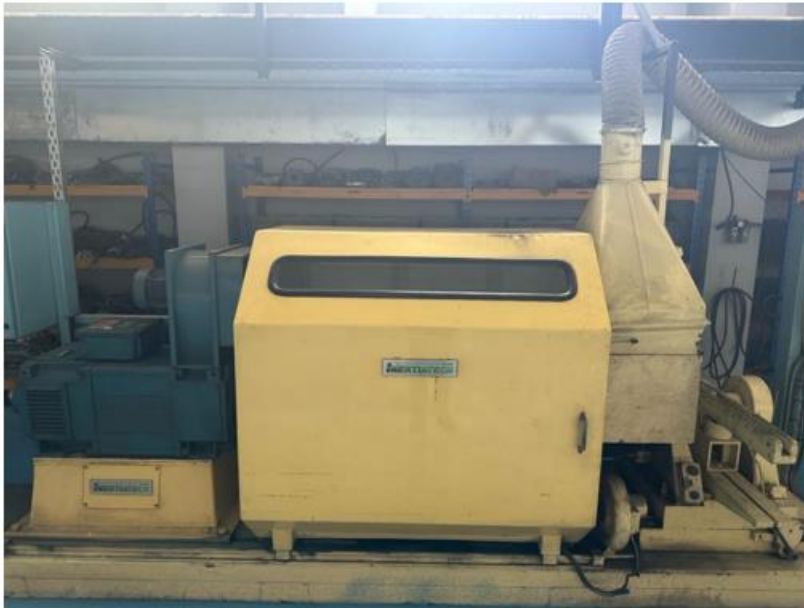
Şekil 2. Aşınma test cihazı ve numune balata görseli
