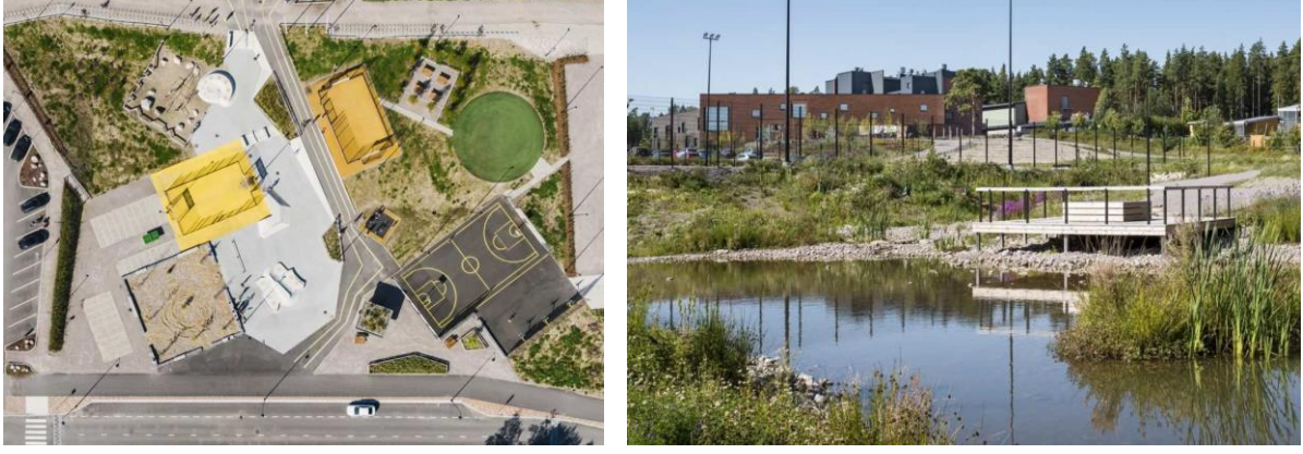
Şekil 3. Sipoonlahti Okulu, herkese açık tasarlanması ve yağmur suyunun sulak alanda toplanması ( Sürücü, 2021 ).
