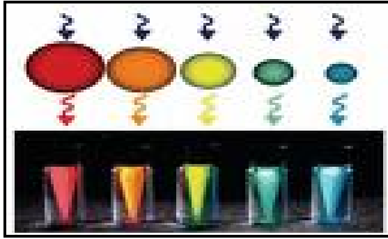
Şekil 1. Farklı boyutlardaki CdSe (kadmium-selenyum) nano parçacıkların yaptığı ışınlar. Yine aynı şekilde nanokristal boyutundaki artışa bağlı olarak dalga boyundaki değişimi Şekil 1.2. deki gibi farklı bir gösterimle temsil etmemizde mümkündür.
