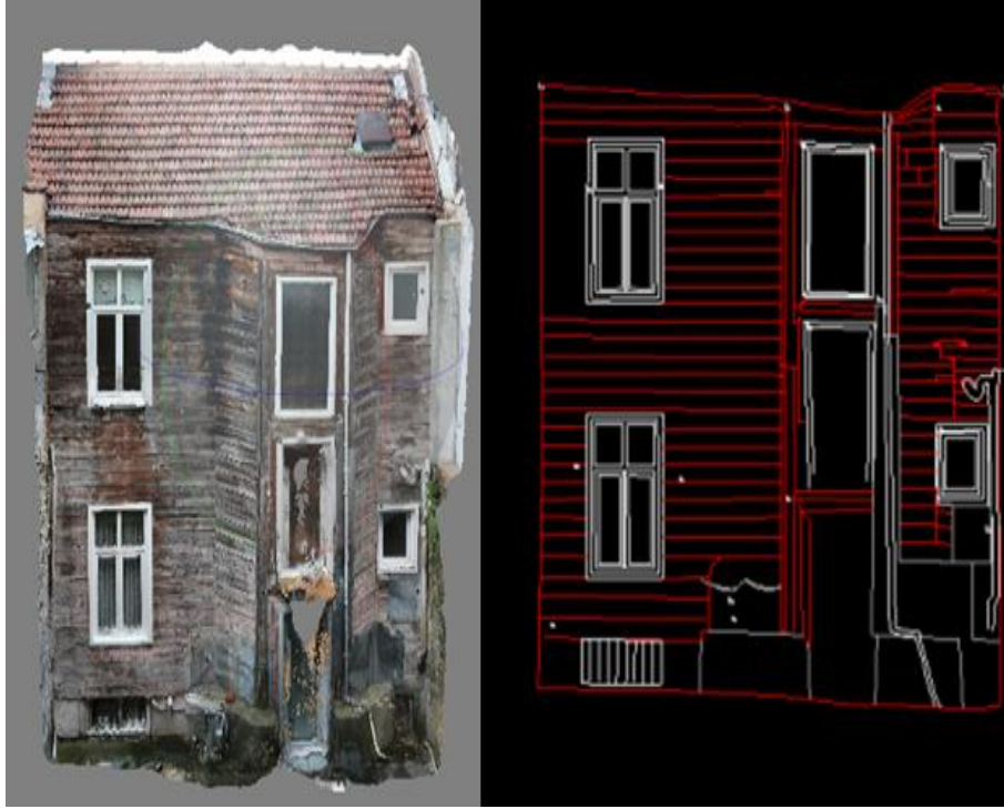
Şekil 10. Arka cephe rölövesi
