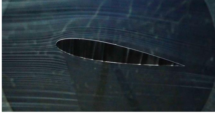
Şekil 8: Akış görüntüleme deneyleri 9 derece.
