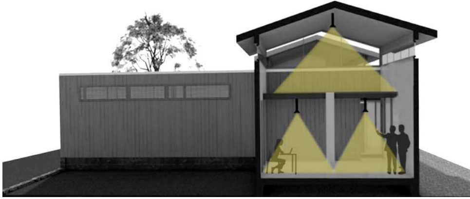
Şekil 15. Yapıda kullanılan yapay aydınlatma yönteminin şematik gösterimi (URL-1).
