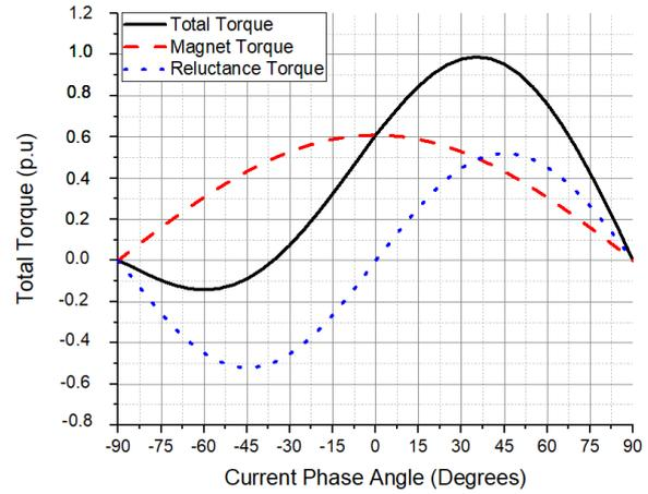
**Figure 3.** The torque component of a PMSynRM (MD-SRM'nin tork bileşenleri)
