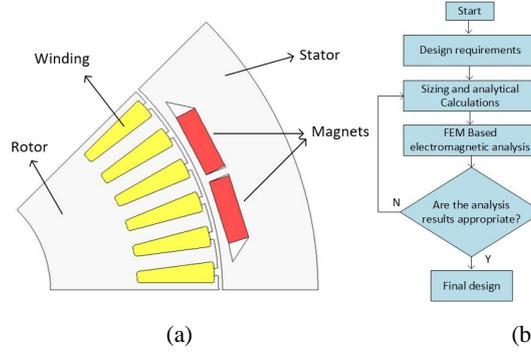
**Figure A:** a) Cross-section of the outer-rotor PMSynRM b) The flowchart of the proposed motor design / **Şekil A:** a) Dış rotorlu MD-SRM'nin kesiti, b) Önerilen motor tasarımın akış şeması
