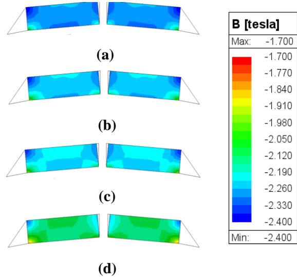
**Figure 11.** Demagnetization performance of the designed motor under different phase currents. (a) 50 A, (b) 75 A, (c) 100 A, (d) 150 A (Tasarlanan motorun farklı faz akımlarında demagnetizasyon performansı)
