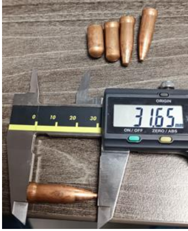
Şekil 10. 600°C CuZn10 Mermi Yüksük Numunesi Derin Çekme Sonrası Boy Uzaması
