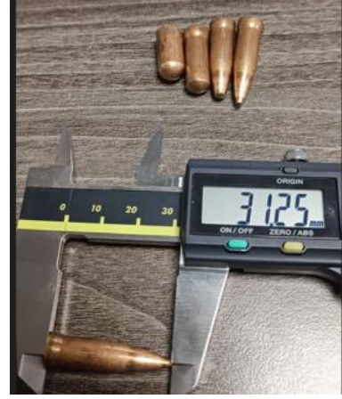
Şekil 8. 400^\circ\text{C} 'de Tavllanmış CuZn10 Mermi Yüksük Numunesi Derin Çekme Sonrası Boy Uzaması
