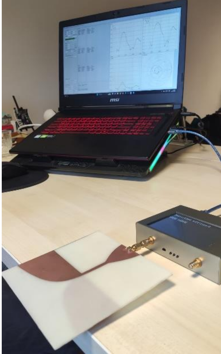
Şekil 19. Anten ile NanoVNA bağlantısı ve ölçüm alınması
