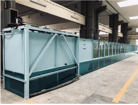
Şekil 2. Deneylerde kullanılan dalga kanalı.
