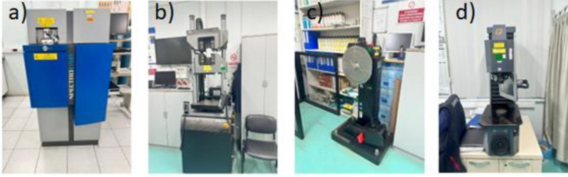
Şekil 6. Testler için kullanılan cihazlar a) Spektrometre cihazı b) Çekme test cihazı c) Çentik darbe test cihazı d) Sertlik test cihazı
