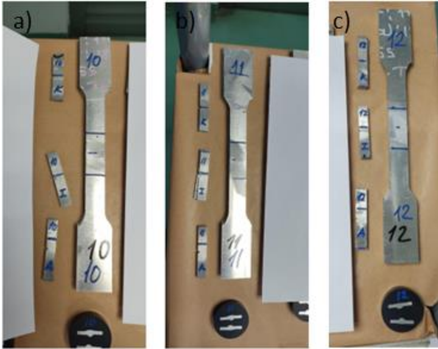
Şekil 5. Kaynaklı parçalardan hazırlanan test numuneleri a) Serbest tel boyu 7,5 mm b) Serbest tel boyu 15 mm c) Serbest tel boyu 25 mm
