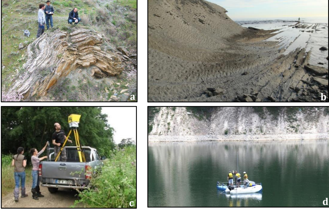
Şekil 1. Jeolojik Saha Çalışmalarına Örnekler. Bir Antiklinoryum Yapısı Üzerinde (a) ve Tabakalı Kayaçalarda Konum Ölçümleri (b). Mikrotopografik Haritalama Çalışmaları (c). Göl Tabanında Paleoklim Kayıtları İçin Karot Alımı (Ocakoglu, Tunoğlu, Dönmez ve Açıklın, 2011) (d).
