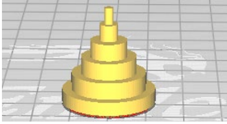
Şekil 7. Boyutsal Doğruluk Test Objesi.
