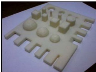
Şekil 2. FDM yazıcı kullanılarak baskı alınan test objesi [11]
