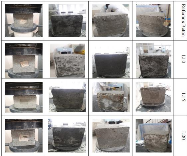
Şekil 11. Küp numunelerin basınç deneyi sonrası kırılma tipleri
