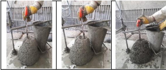
Şekil 7. Numunelerin slump deneyi Figure 7. Slump test of samples
